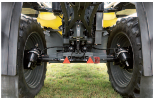
Obr.: Náprava ComfortTrack je říditelná a během otáčení následuje stopu traktoru. Rozchod lze nastavit od 1,8 m do 2,25 m
