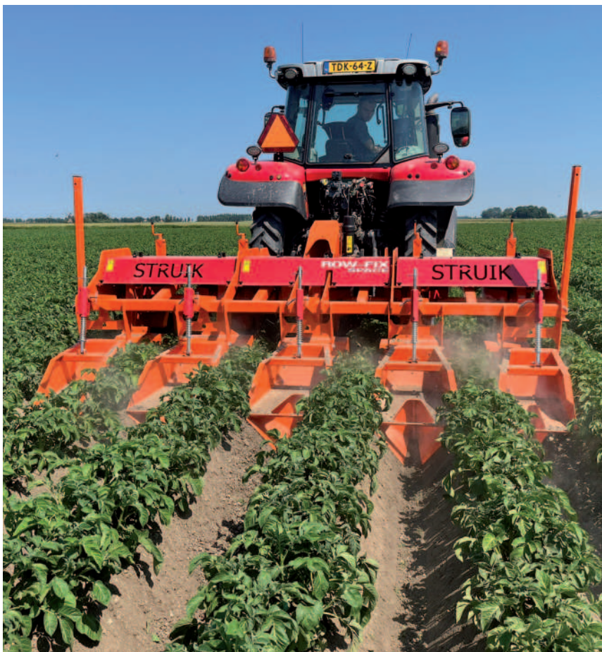
Obr.: Plečka speciálně vyvinutá pro mechanické hubení plevelů v řádcích mrkve či petržele a na záhonech se zeleninou.
