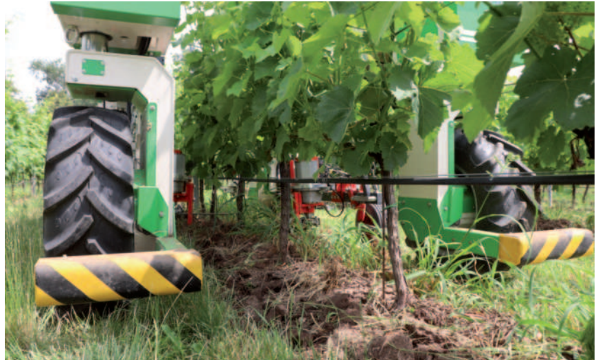
Obr.: Senzory rozpoznají člověka stojícího v řádku.
