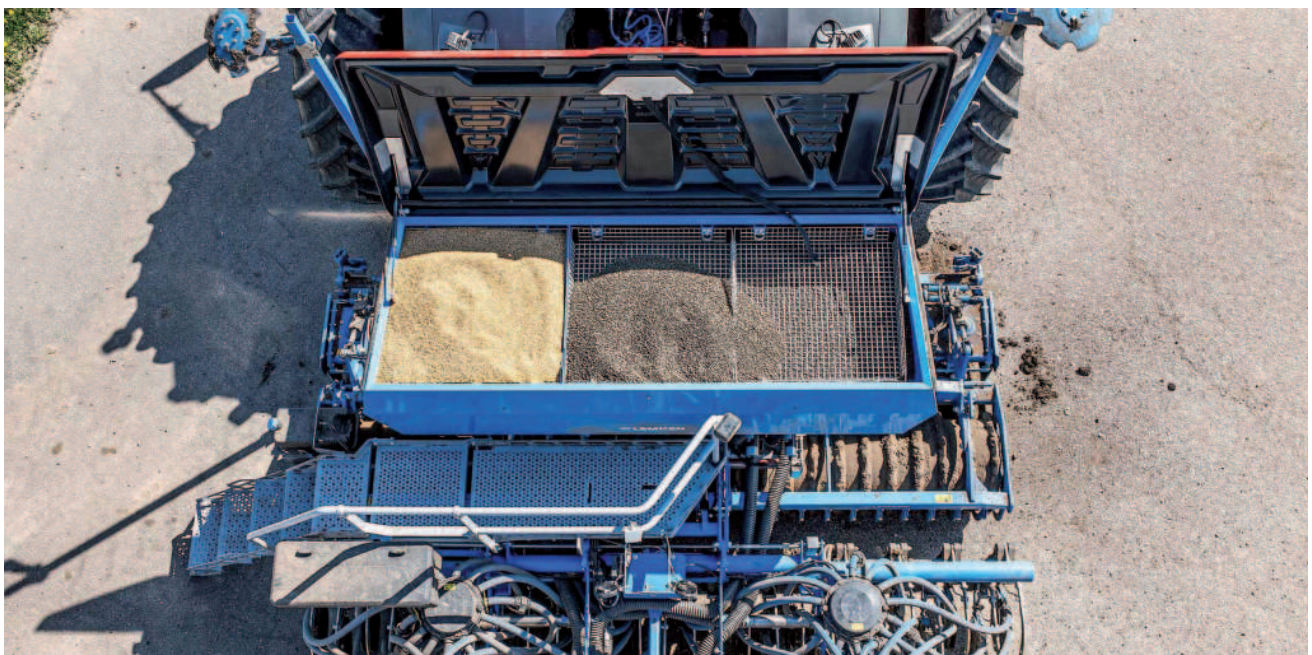
Obr.: Řada secích strojů Lemken Solitair MR je vybavena zásobníkem o objemu 1 500 litrů vhodným i pro hnojivo.
