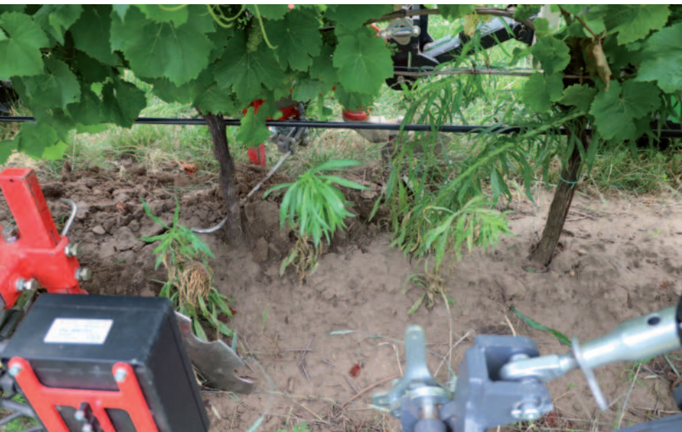
Obr.: Zde můžeme vidět práci aktivní elektricky poháněné okopávačky.
