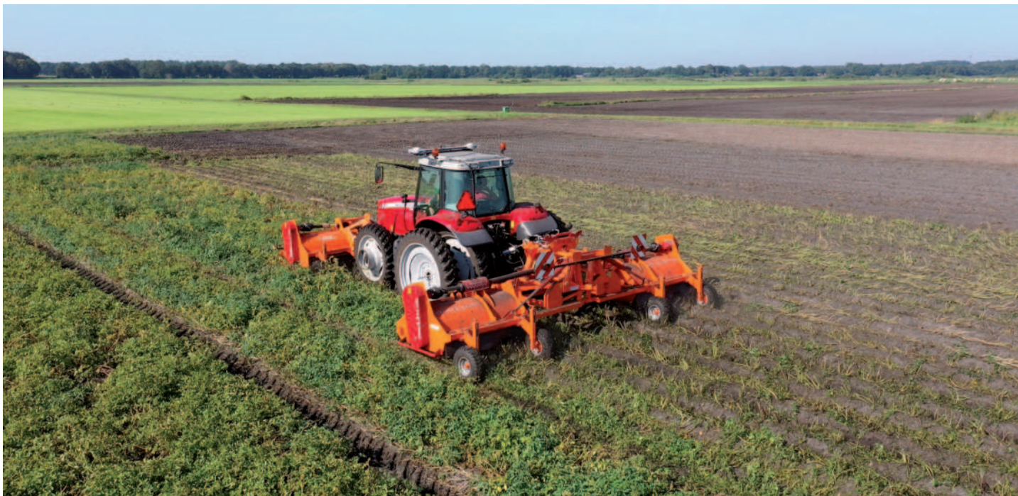
Obr.: Drtič umožňuje účinné ekologické rozdrčení bramborové natě před sklizní.
