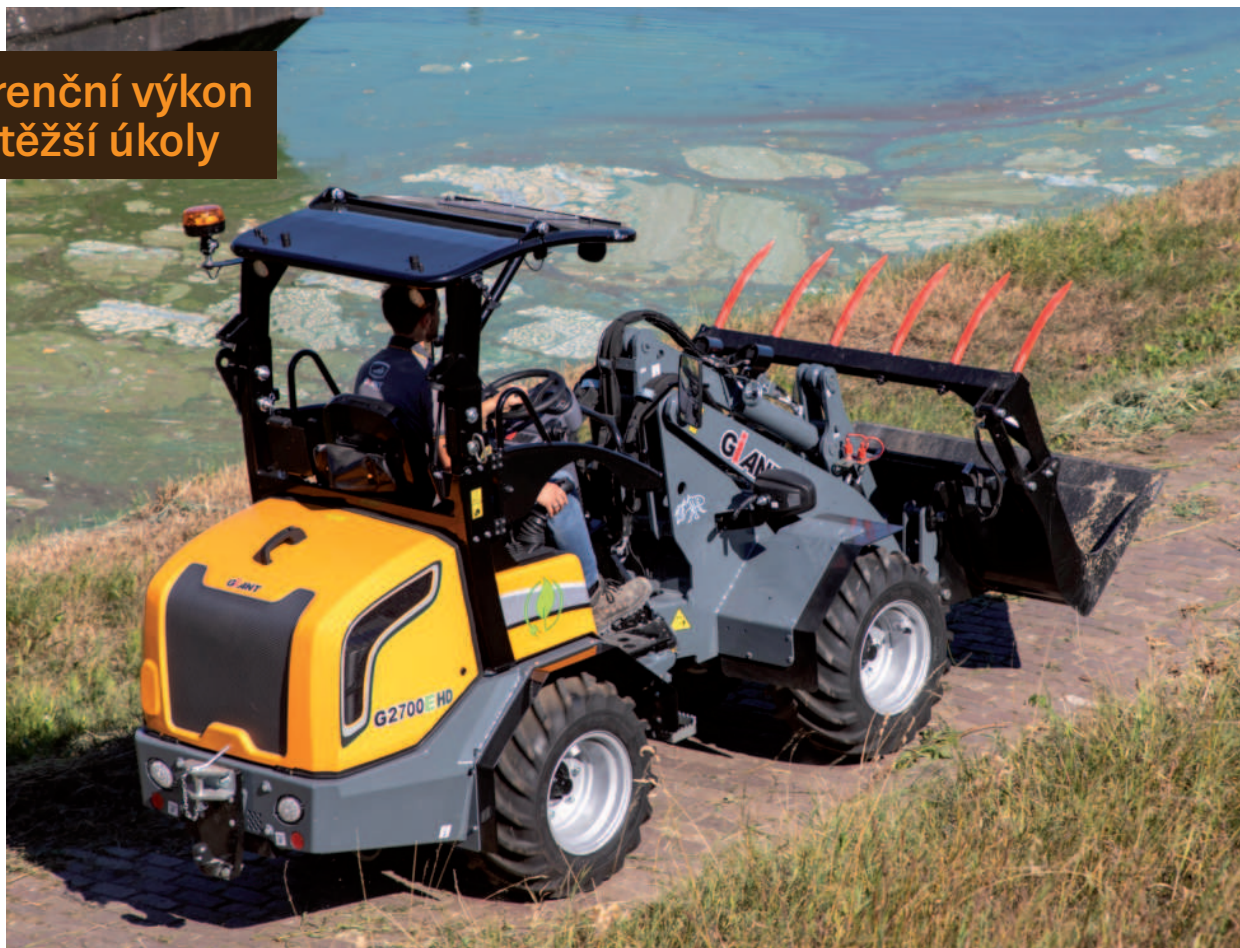
Obr.: Nakladače TOBROCO-GIANT G2700E HD disponují motorem o výkonu 13 kW.
