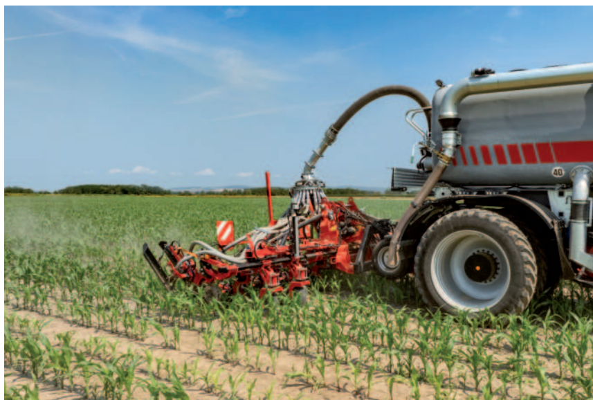
Obr.: Holmer ScetaFlex SL váží 2 300 kg a je určený pro závěsné systémy KAT II/III.
