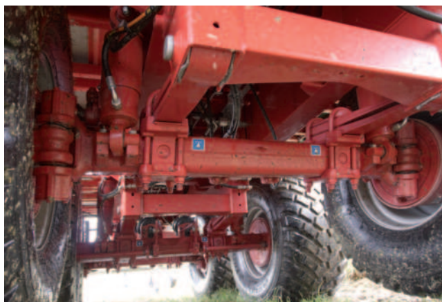
Obr.: Podvozek je možné dodat v provedení s odpružením listovými pery, nebo ve hydropneumatické variantě (na snímku).
