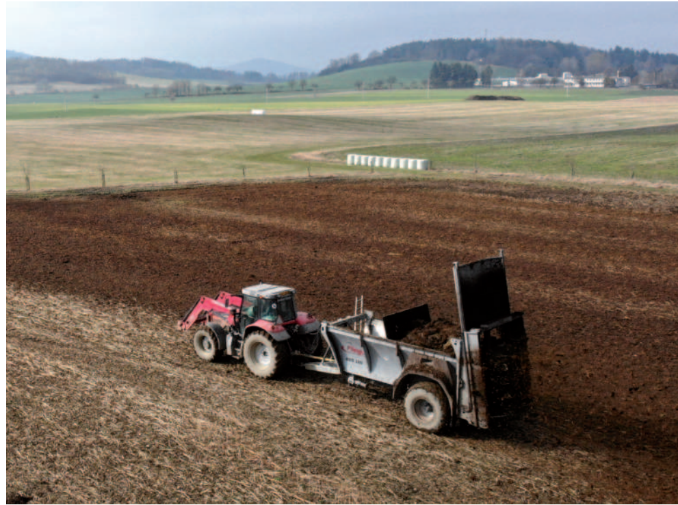
Obr.: Robustní rozmetadlo s vertikálně umístěnými frézovacími válci a šířkou rozmetání až do 12 metrů umí pracovat jak se suchým, tak s vlhkým materiálem.
