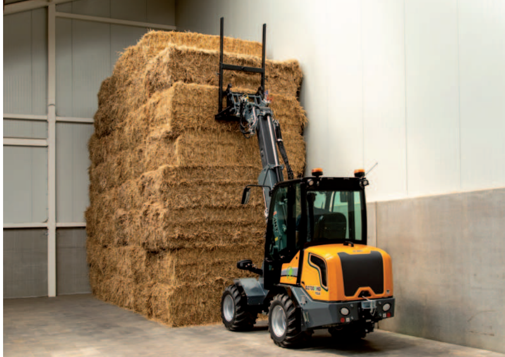
Obr.: Elektrický nakladač GIANT G2700E HD TELE s teleskopickým ramenem disponuje výškou zdvihu 3,7 m.
