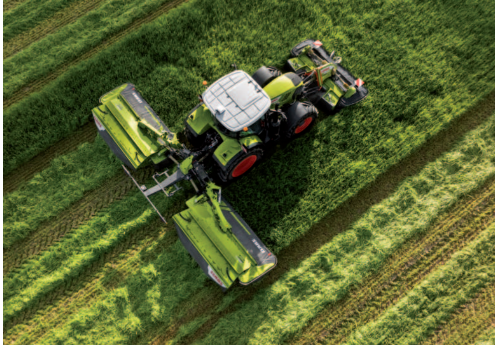
Obr.: Claas Disco 1100 Comfort v kombinaci s čelním žacím strojem Claas Disco 3600.
