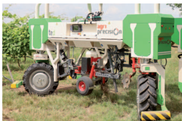
Obr.: Robot má čtyři kola a v každém z nich elektromotor.
