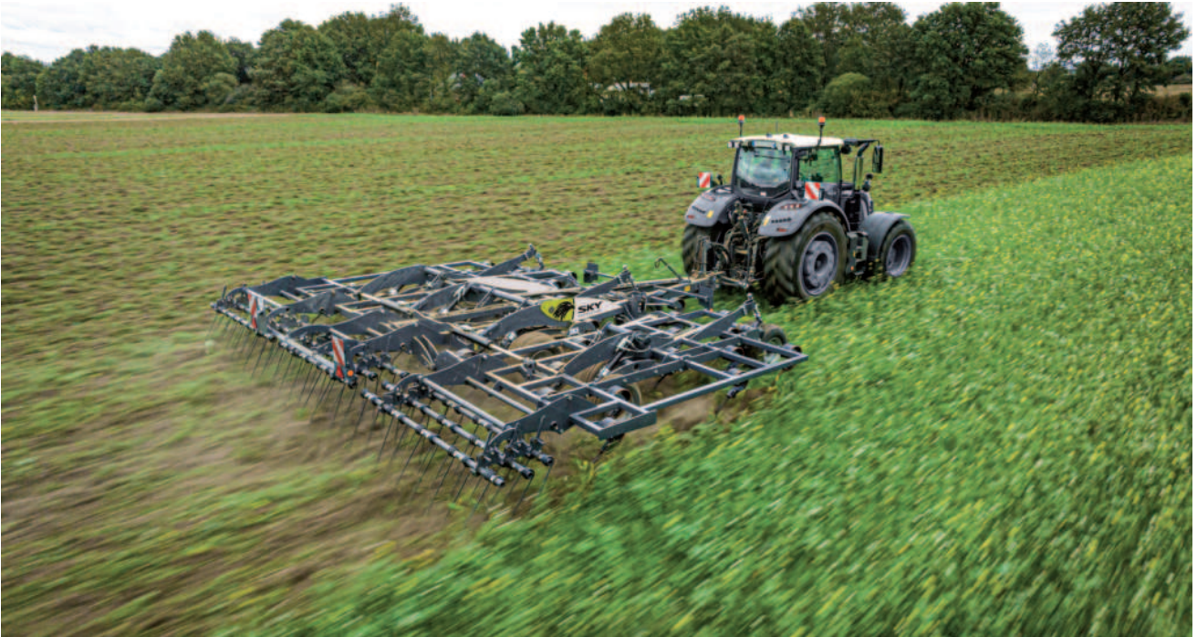
Obr.: Radličkový stroj SKY Methys PCS je navržen pro celoplošné podříznutí povrchu, což umožňuje mechanické odstranění plevelů, mezplodin, strniště či porostu jetele.
