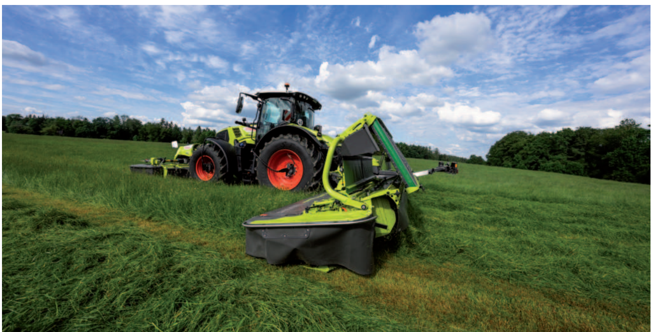
Obr.: Uchycení pásových jednotek Auto Swather u žacího stroje Claas Disco 9300 C Auto Swather bylo optimalizováno tak, aby zvládalo i těžké nasazení.
