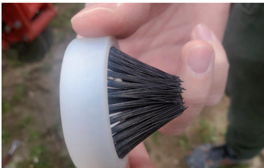
Obr.: Na kartáči se nahromadí požadovaná dávka hnojiva, která je uložena k osivu nebo mezi osivo.
