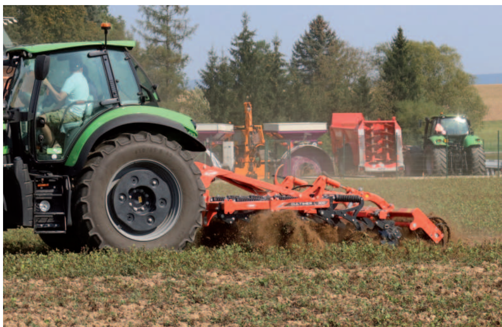
Obr.: Kypříče Kuhn Cultimer L 300 umí provádět podmítku strniště v rozmezí 3–7 cm.
