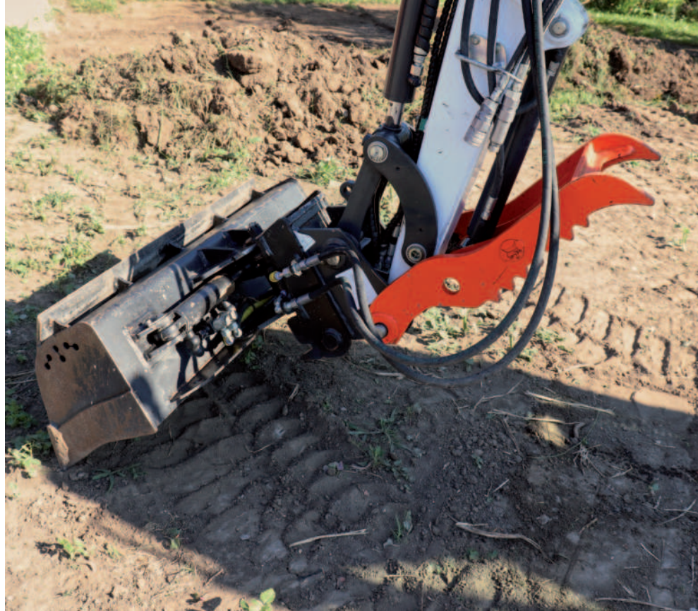
Obr.: Svahová radlice a přidržovač. Výměna příslušenství se provádí přes hydraulický rychloupínací systém.
