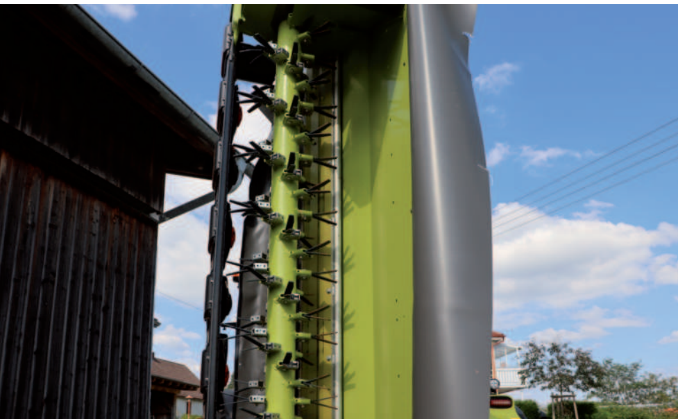
Obr.: Integrovaný prstový kondicionér zaručuje výrazné urychlení zavadání i v hustých porostech a při krátkých obdobích příznivého počasí. Foto: Milan Jedlička
