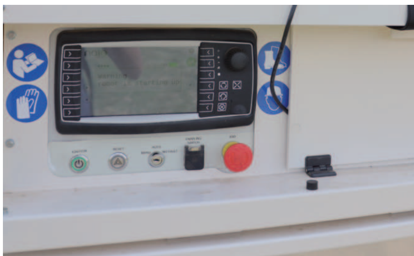
← Obr.: Na robotu se nachází displej pro základní nastavení práce.
