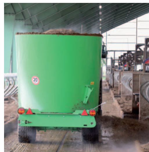
Obr.: V zadní spodní části vozu je umístěn výsypný otvor, kterým materiál při míchání volně padá na dopravník.
