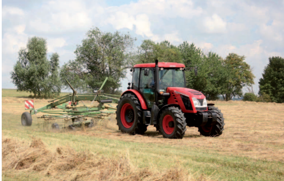
Obr.: Shrnutí posečené hmoty do řádku zajišťuje spolehlivě dvourotorový shrnovač Krone Swadro.
