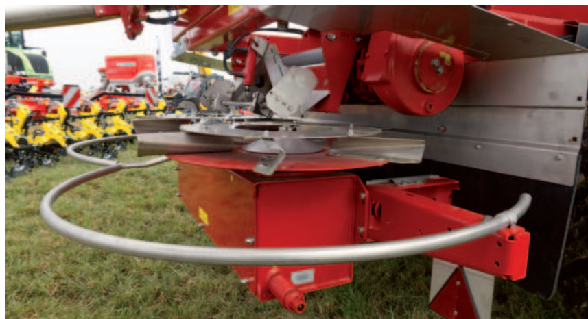
Obr.: Aplikace hnojiva se provádí přes šestilopátkové nebo čtyřlopátkové disky.
