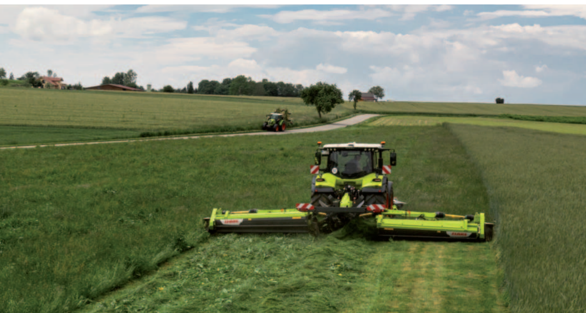
Obr.: Nový žací stroj Claas Disco 9300 Direct Swather nabízí čtyři strategie sečení a ukládání posečené hmoty.
