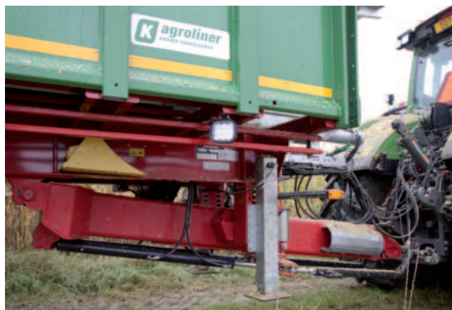
Obr.: návěs Kröger TAW30 byl agregován s traktorem Fendt 939 Vario. Oj může být v mechanicky stavitelném provedení.
