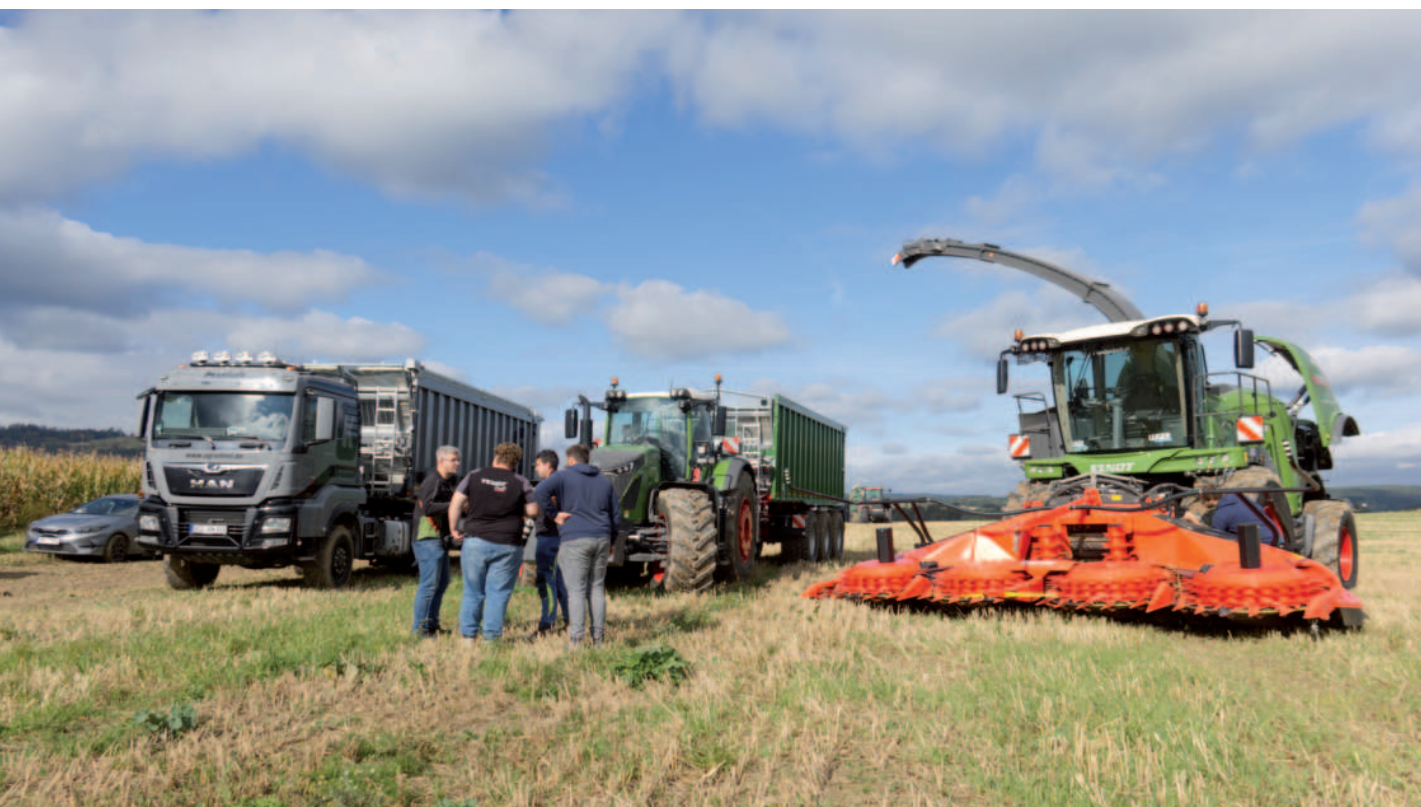
Obr.: Dopravní technika Kröger Agroliner před předváděním Sklizeň kukuřice zajišťovala samojízdná řezačka Fendt Katana 650 s osmiřádkovým sklízecím adaptérem Kemper. Foto: Věra Hejhálková
