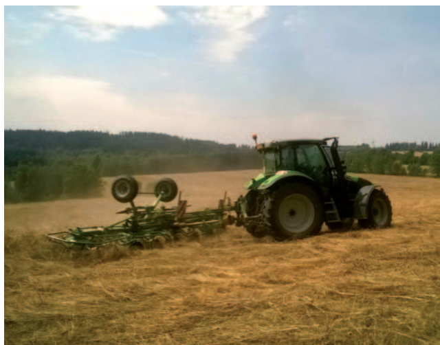
Obr.: O obracení píce se stará rotorový obraceč Krone.
