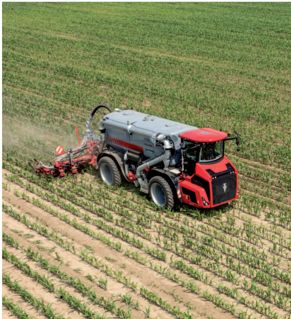
Obr.: V České republice byl aplikátor předváděn ve spojení s výkonnějším modelem Holmer Terra Variant 650 osazeným dvojmontáží kol pro jízdu mezi řádky kukuřice.
