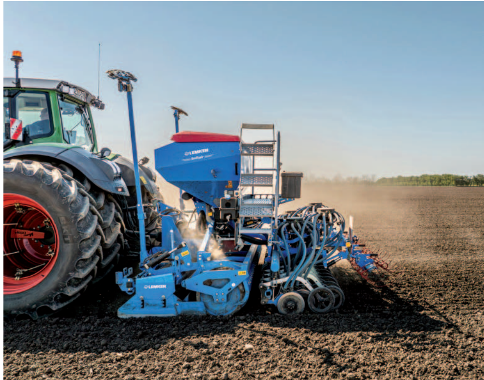
Obr.: Secí stroj může mít integrované rotační brány Lemken Zirkon MR nové generace pro přípravu setového lůžka.
