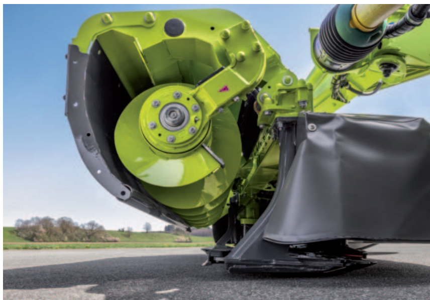
Obr.: Claas představil žací stroj se šnekem. Šnek vychází z adaptéru pro přímou sklizeň určených pro samojízdné rezačky.
