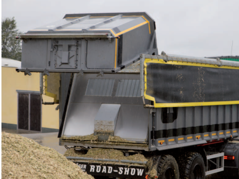
Obr.: Návěsy s posuvnou podlahou a výtlačným štítem Kröger jsou schopné stlačit přepřavovaný materiál. Vykládku lze díky tomu uskutečnit i tam, kde není možné používat sklápěcí návěsy (nízké budovy, přístřešky apod.)
