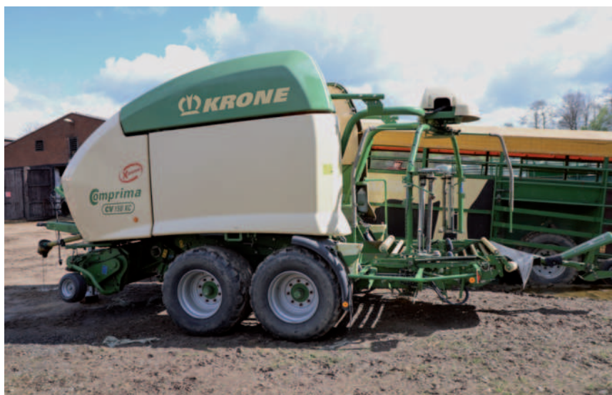
Obr.: Ročně na farmě potřebují slisovat čtyři tisíce balíků senáže. K tomu je využíván kombinovaný lis Krone Comprima CV 150 XC. Foto: Milan Jedlička
