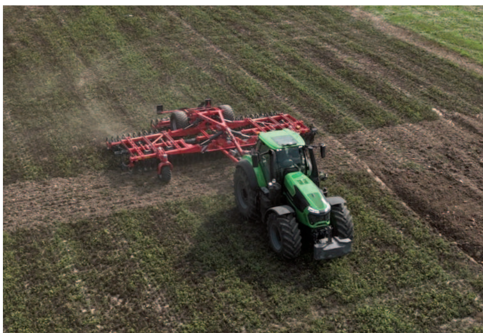
Obr.: Podmítač Kuhn Optimer L 6000 je určen pro mělké zpracování půdy do 10 cm.
