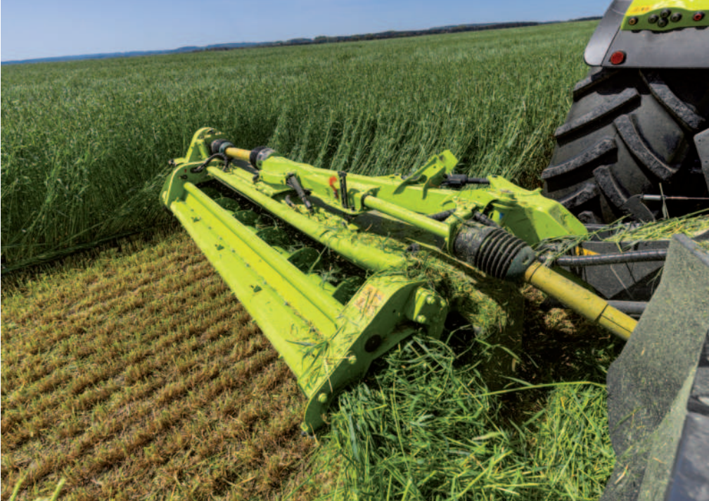
Obr.: Horní pohon šneku umožňuje kdykoli hydraulicky otevřít šneky.
